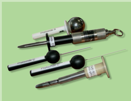
Sondes d'essai suivant DIN EN 60529
