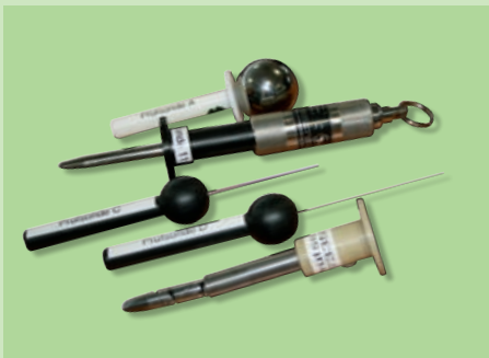
Sondes de test selon DIN EN 60529
